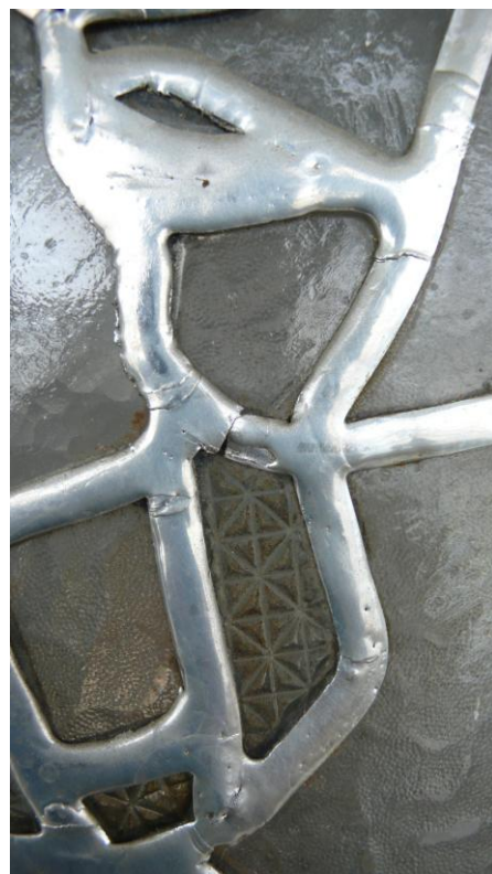
příklady řemeslně nezvládnuté práce s olověným profilem a jeho cínování
